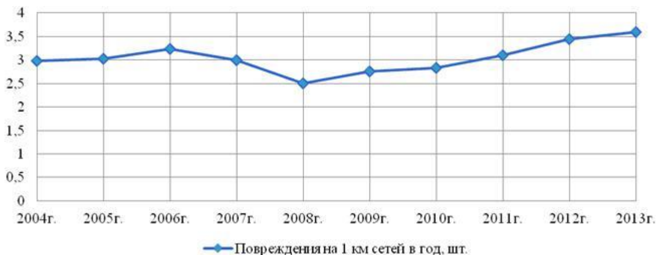
Рис.5. График количества повреждений на 1 км водопроводных сетей в год за отчетный период
