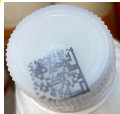
Смещение кода маркировки при печати
