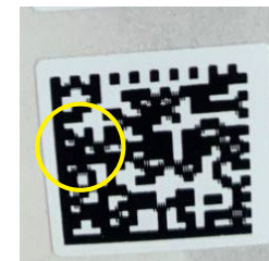
Смазывание кода маркировки или его отдельных элементов
