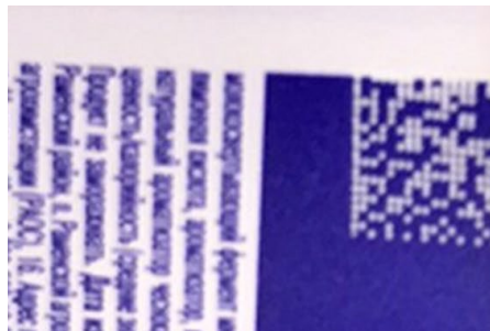
Отсутствие зоны покоя с одной из сторон
