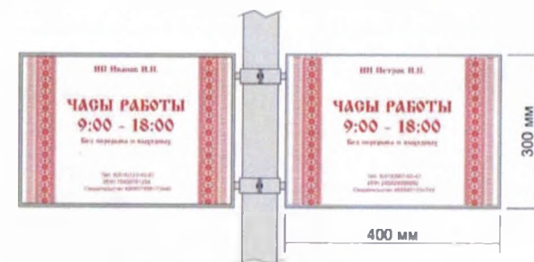
Рис. 33 – Крепление информационной таблички
